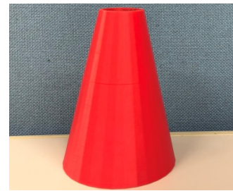
図1. 3Dプリントをしたベル (全長10.7cm, 直径21.9mm～63.5mm)
